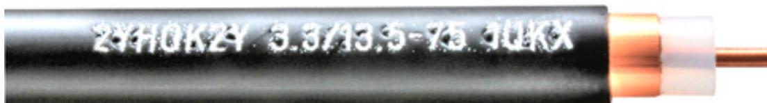
**Verwendung:** Zur Signalübertragung in Breitband-Kommunikationsnetzen (z. B. Kabelfernsehen) zwischen Kopfstation und Hausanschluss. Sie entsprechen DIN 50117, Teil 3 (Hausanschluss) und Teil 4 (Verteiler- und Linienkabel) und sind typgeprüft nach FTZ-Norm. Längsgeschweißte Kupferrohre sorgen für optimale Störsicherheit und hervorragende Stabilität bei Biege- und Druckbeanspruchungen. Auch für Erdverlegung in privaten BK-Anlagen (bis 2 GHz).
